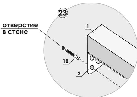
24. Установите экран на место и зафиксируйте к стенам при помощи шурупов 4,2x50 (рис. 24).
