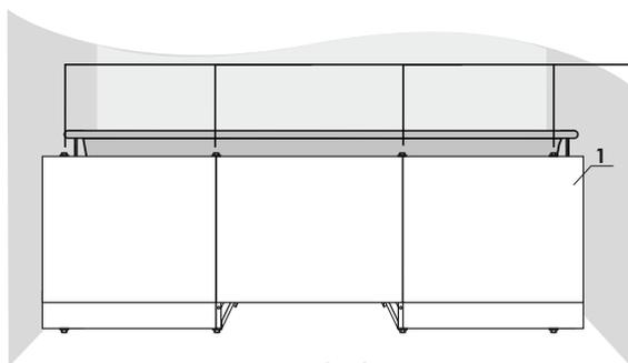
Выставьте экран по уровню, выкрутите распорные подпятники, обеспечив зазор между экраном и бортиком ванны 1-2 мм.
