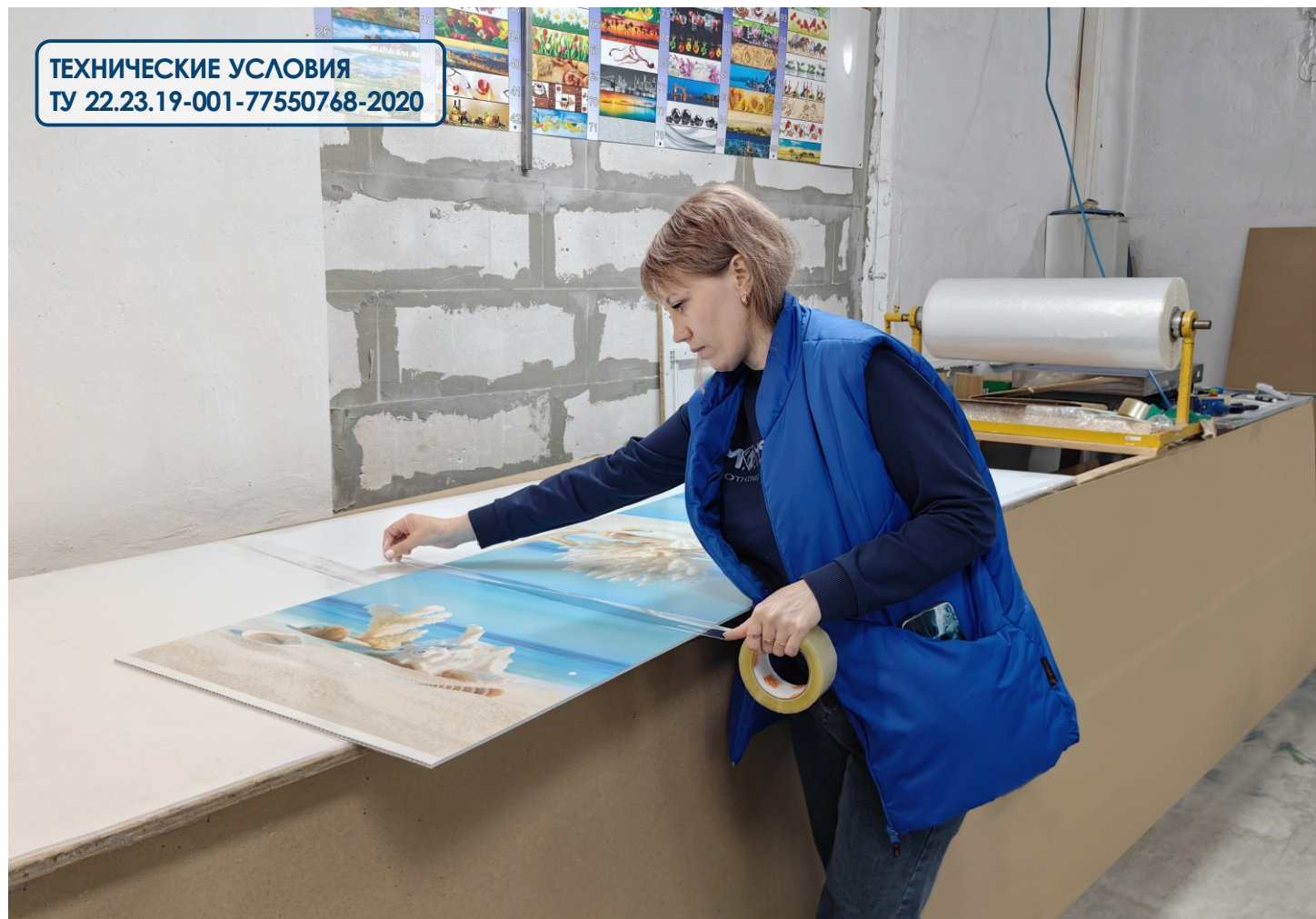
• Результат: на липкой ленте нет следов краски, поверхность панели без видимых повреждений
