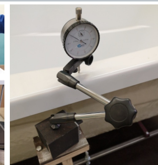
• Распределённая нагрузка на дно изделия
