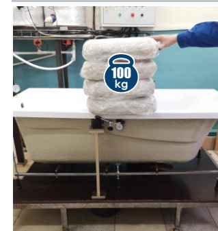
• Сосредоточенная нагрузка на дно изделия
