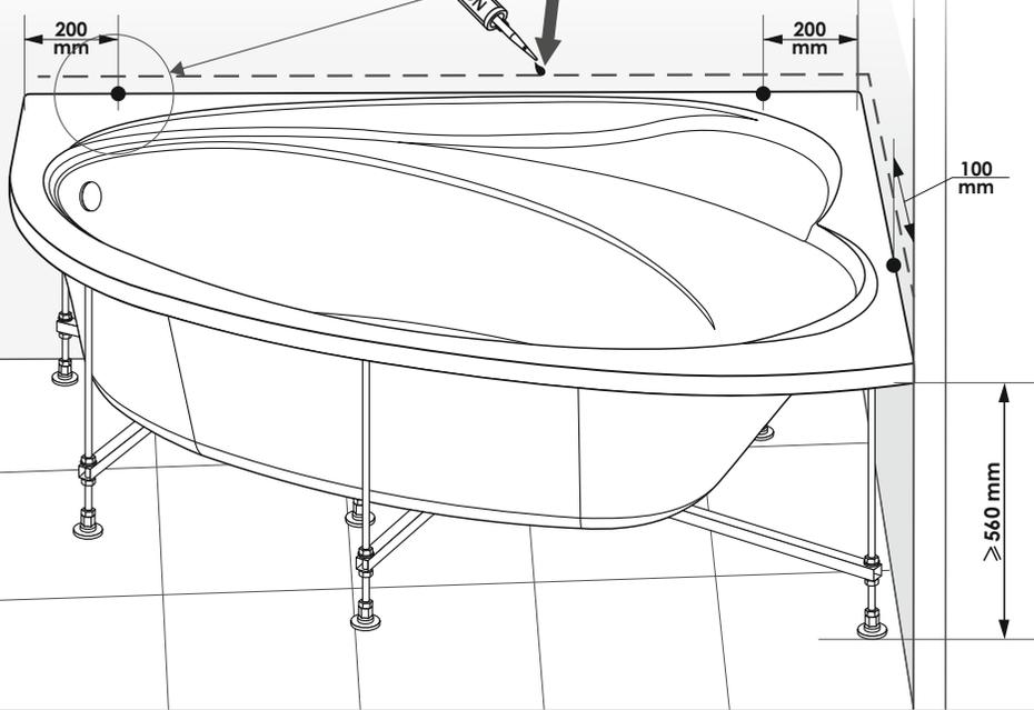
Инструкция по монтажу акриловой ванны на металлический каркас
