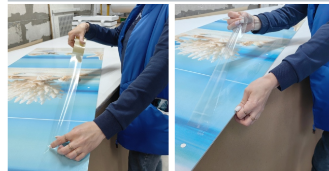
• Результат: на липкой ленте нет следов краски, поверхность панели без видимых повреждений
