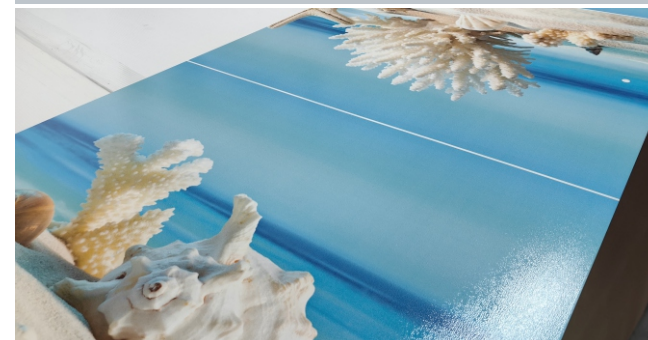
• Результат: на липкой ленте нет следов краски, поверхность панели без видимых повреждений
