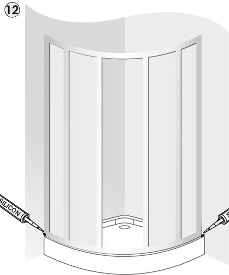
11. Нанесите герметик на душевой поддон в месте соприкосновения с нижней дугой каркаса, установите ограждение, заправив в установочные профили (п. 3). См. рис. 12
