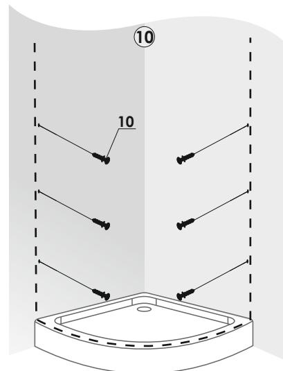
10. Нанесите герметик в паз установочного профиля (п.3) и в места соприкосновения профиля к стене, закрепите его к стене шурупами 4x70 (п.12). См. рис. 11.
