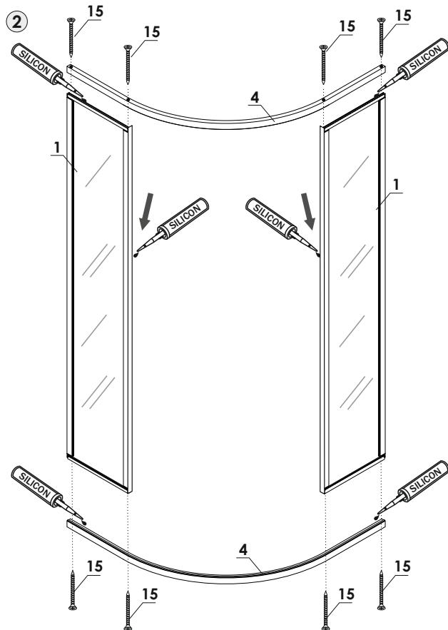
3. Закрепите при помощи ШУЦ 4x35 (п.15) неподвижные панели к дугам каркаса, предварительно смазав места соприкосновения силиконовым герметиком (рис.2).
