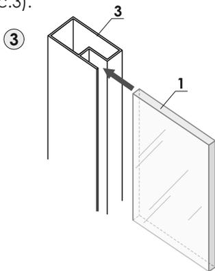
4. Второй вертикальный профиль задвиньте на свободный край стекла. Используя шурупы 4x45, соедините всю конструкцию в замкнутую рамку (рис.4).
